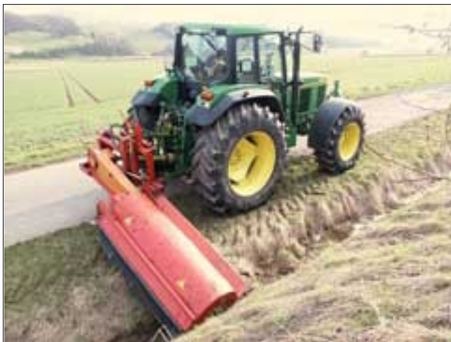
Seitenmäher beim Schlegeln einer Grabenvorderseite.
