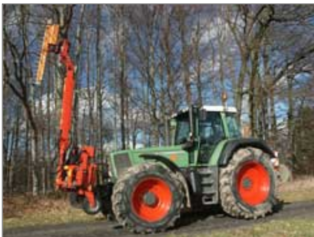
Die Heckenschere beim Schneiden eines Lichtraumprofiles.
