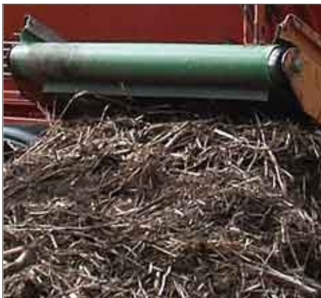
Durch das Schreddern entstehen in Abhängigkeit von der Umlaufdauer Stücke von 0 - 30 cm.
