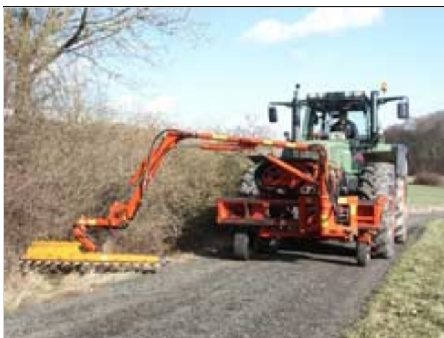
Die Heckenschere beim Zurückschneiden der Stockausschläge.
