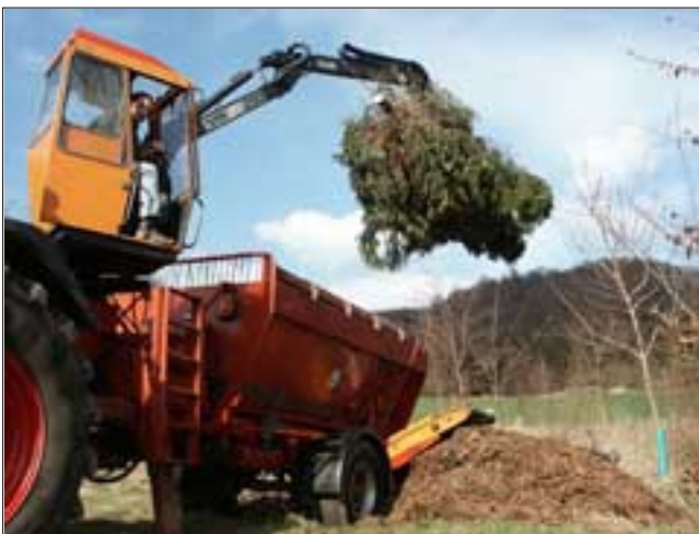
Der zum Schredder gehörige Kran besitzt eine Hublast von 1150 kg.
