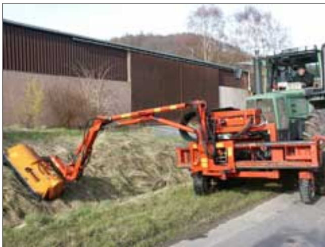
Der flexible Schlegelmähkopf beim Mulchen einer gegenüberliegenden Grabenseite.
